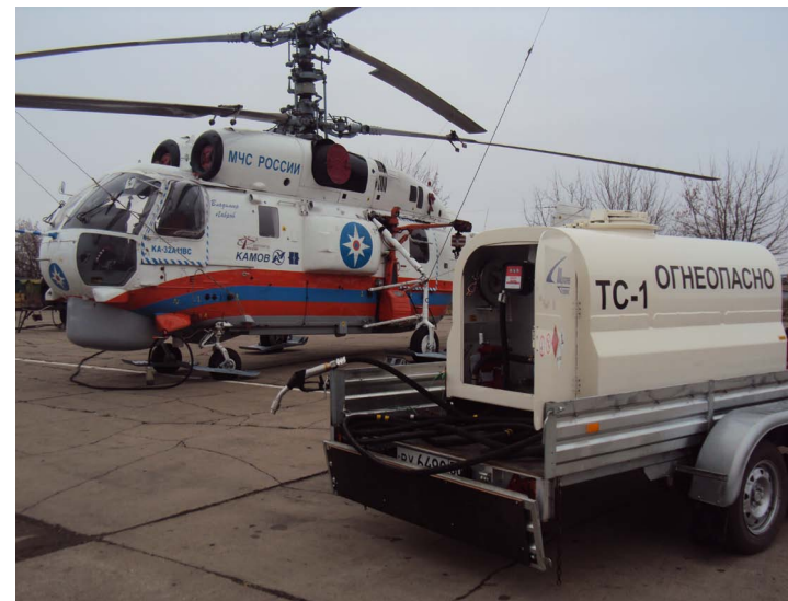
Фото 7. Установка заправки с цистерной на 920 л на прицепе
