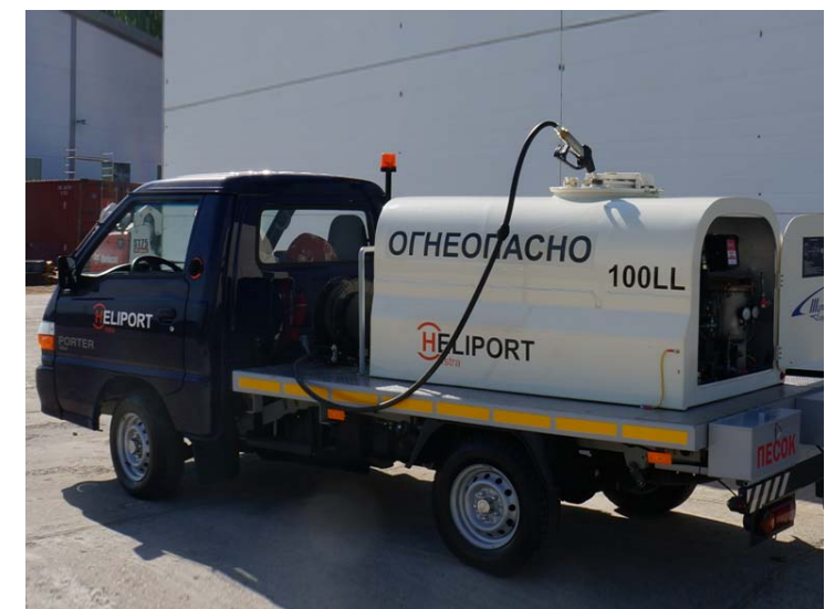
Фото 8. Установка заправки с цистерной 920 литров на шасси
