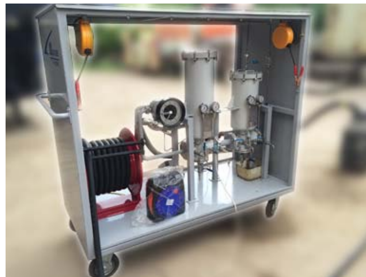
Фото 5. Установка заправки топлива со скоростью 100 л в минуту с системой фильтрации и водоотделения топлива
