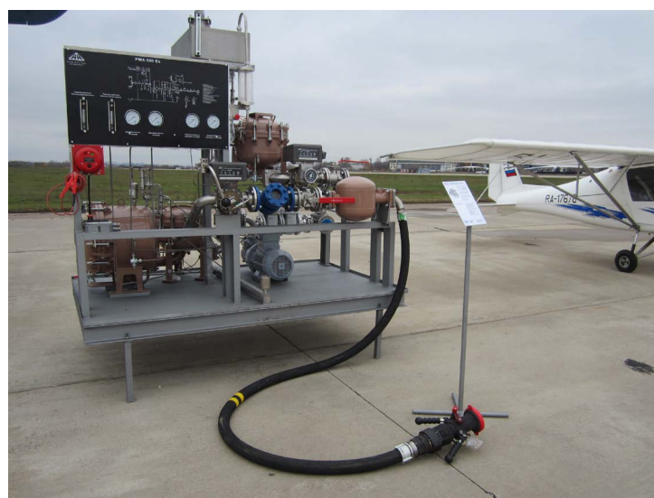
Фото 4. Универсальная установка заправки типа PMA-550 с возможностью фильтрации, учета и дозирования ПВК-жидкости
