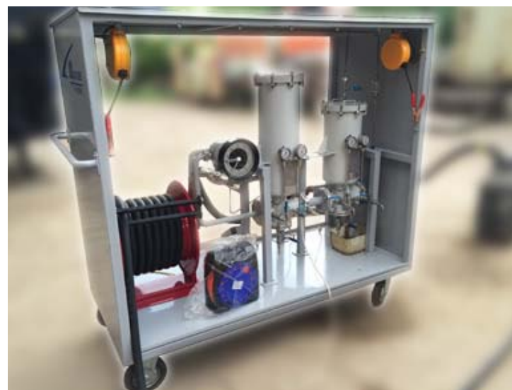
Фото 5. Установка заправки топлива со скоростью 100 л в минуту с системой фильтрации и водоотделения топлива
