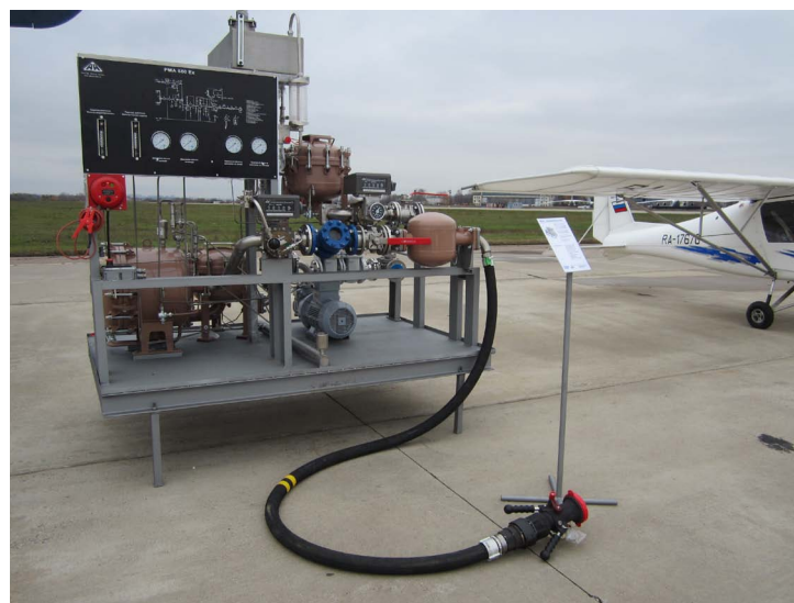
Фото 4. Универсальная установка заправки типа РМА-550 с возможностью фильтрации, учета и дозирования ПВК-жидкости
