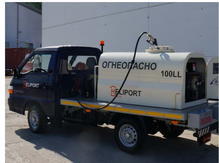
Фото 8. Установка заправки с цистерной 920 литров на шасси
